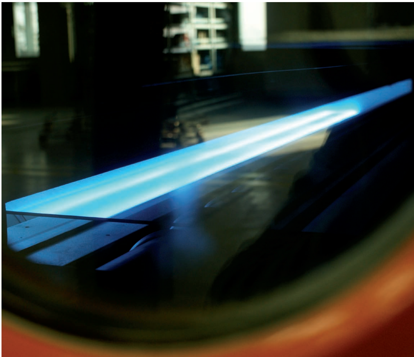
超过5,000小时的湿热测试已经证明真空沉积ARC经久耐用，支持者声称它创造了更易于处理的玻璃表面。
