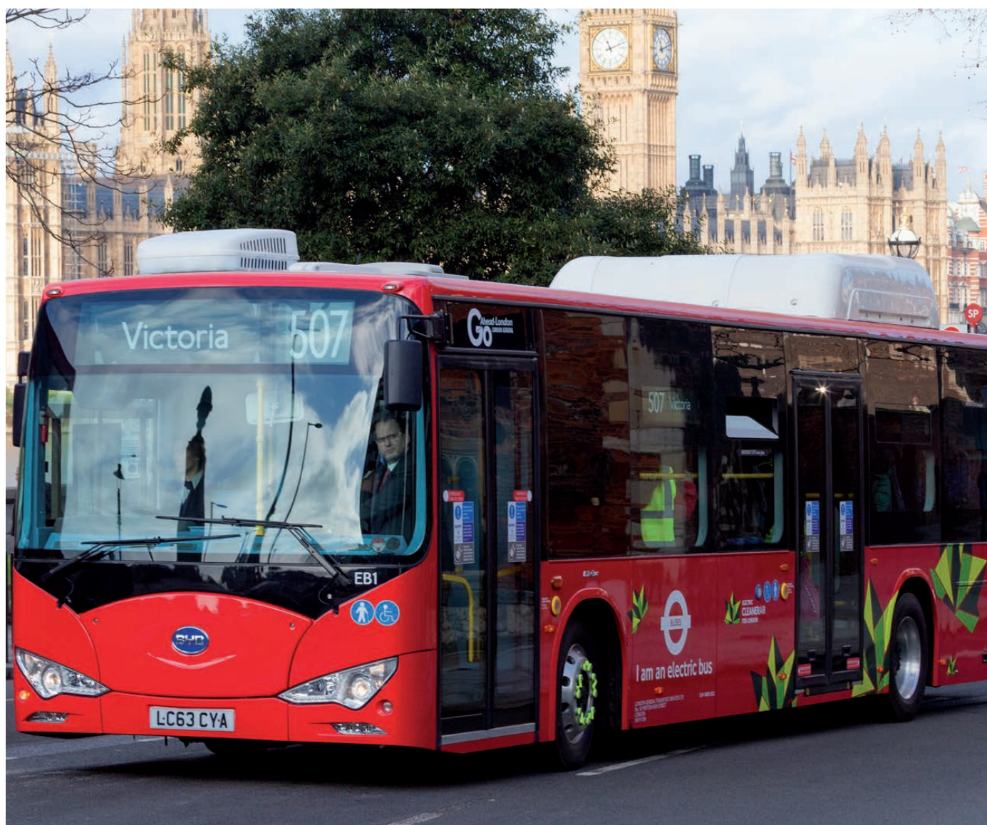
比亚迪在伦敦的电动公共汽车。据比亚迪计算，在城市运输中使用的比亚迪电动公共汽车，其使用寿命介于八年至十年。在这些电动公共汽车报废之后，比亚迪的磷酸锂电池仍保有其原容量的70%，可以继续用于储能系统中。
